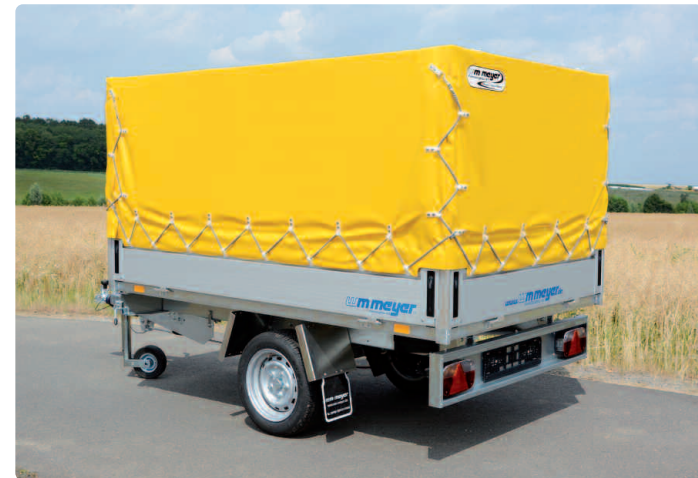
Zubehör: Alulaubaufsatz, Sonderplane gelb Option : rehausse en alu, bâche spéciale jaune Optional extra: aluminium extension sides, special canvas top (yellow)
