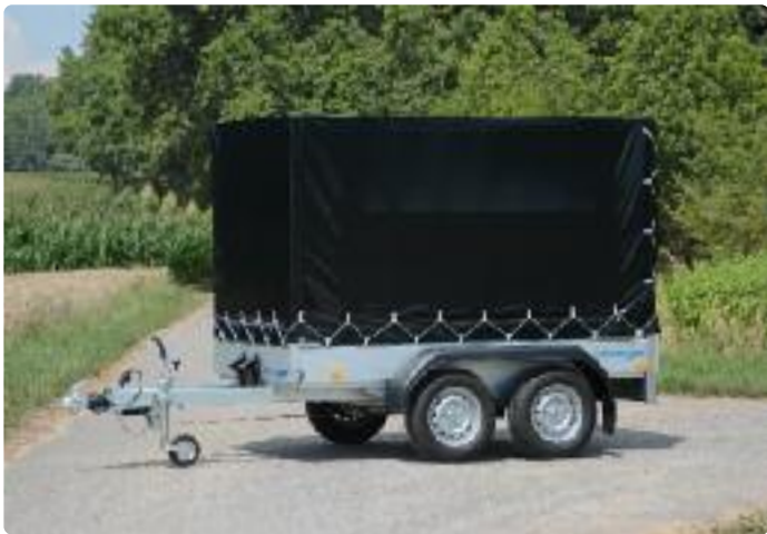
BT 2025/126 Zubehör: Plane und Aluspriegel (Höhe: 1.400 mm) BT 2025/126 Option : bâche et ossature en aluminium (hauteur : 1.400 mm) BT 2025/126 Optional extra: canvas top, aluminium support (height: 1,400 mm)
