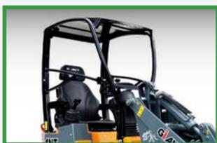
Modèle standard livré avec toit de sécurité ROPS/FOPS, incl. portes de protection à gauche et à droite.
