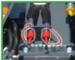
Fonction hydraulique à double effet sur le bras de levage (à commande mécanique)
